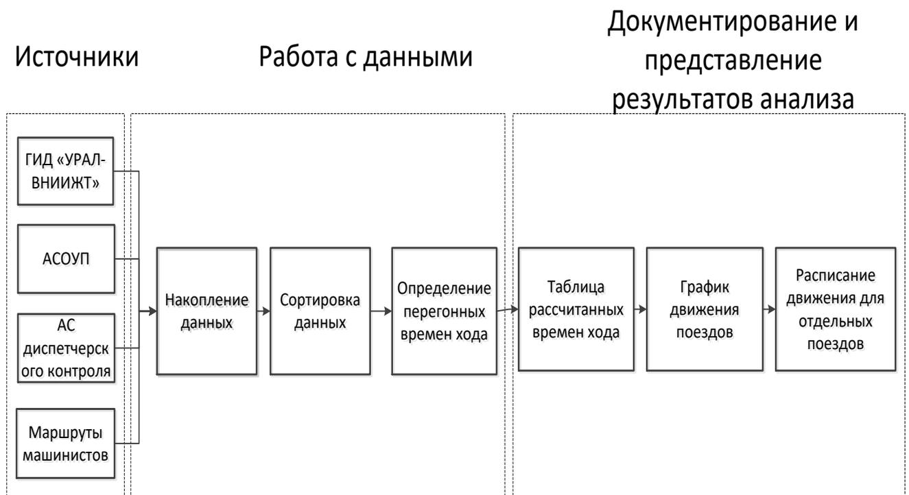
Рисунок 8 – Схема реализации процесса расчета перегонных времен хода
